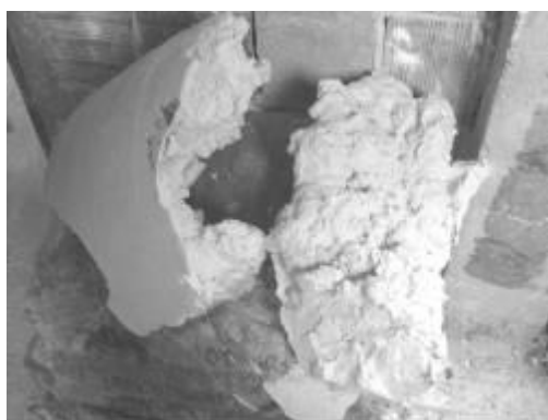
Figura 1 - Resíduo da pasta de gesso proveniente da própria masseira de um aplicador sem treinamento
