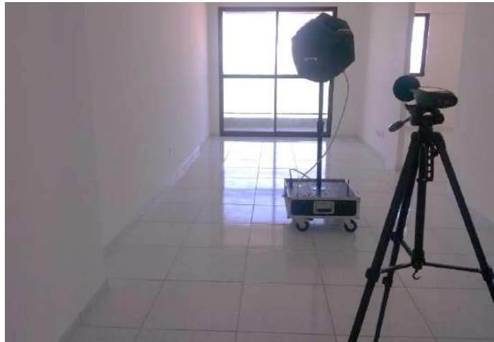
Figura 17 - Medidor de nível de pressão sonora e fonte de ruído
