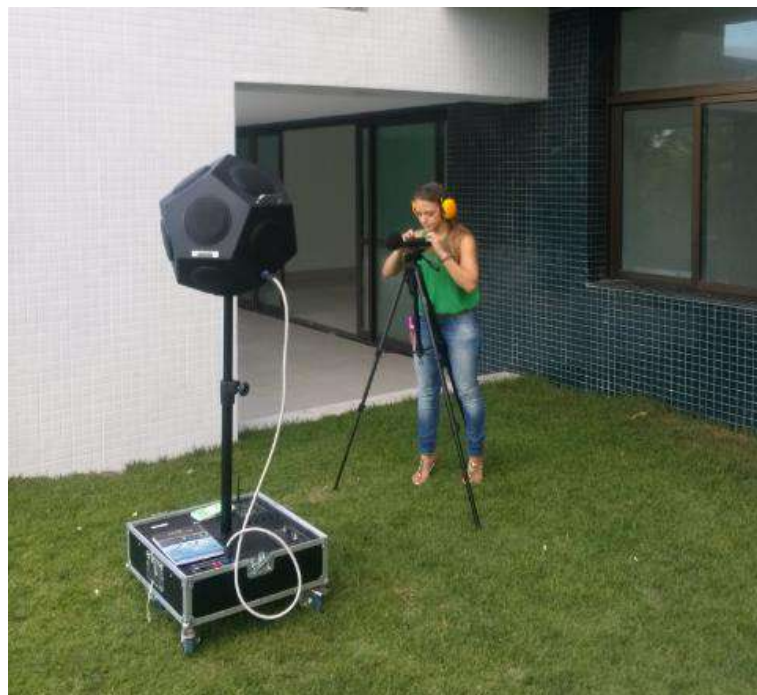
Figura 21 - Coleta do ruído de emissão para o ensaio na vedação externa
