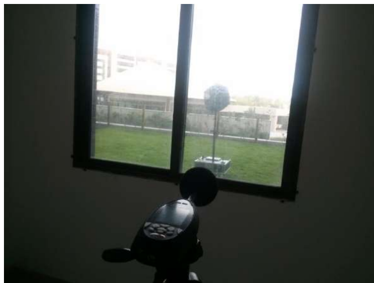
Figura 22 - Coleta dos ruídos de fundo e de recepção para o ensaio na vedação externa
