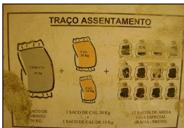
**Figura 4.12** - Traços utilizados na execução da alvenaria
