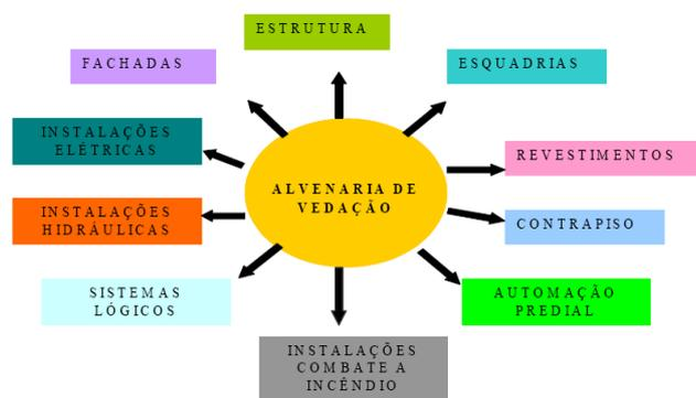
**Figura 2.1:** Interatividade entre os diversos subsistemas construtivos com a alvenaria de vedação (CORRÊA, 2006)
